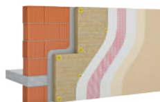
webertherm XM roche mode de pose calé-chevillé
