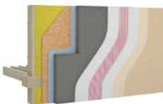
webertherm XM PSE COB mode de pose collé
