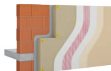
webertherm XM Fibre de Bois mode de pose calé-chevillé
