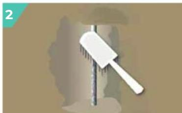
2 Éliminer la rouille non adhérente à la brosse métallique ou par sablage. Dépoussiérer soigneusement. Si des résidus de rouille subsistent, appliquer **PASSIFER**.
