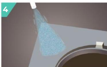
Protéger l'ouvrage de la dessiccation en pulvérisant à sa surface un produit de cure ou en le recouvrant d'un polyane ou d'une bâche humide. L'ouvrage peut être remis en circulation au bout de 2 h.
