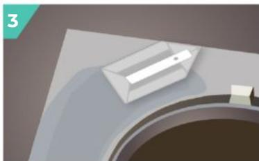
Réaliser la finition à la taloche bois ou plastique avant le début de prise du micro-béton.
